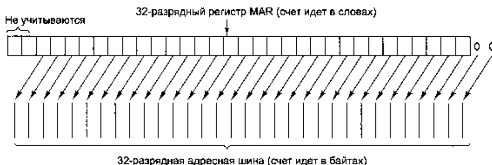
Рис. 4.3. Распределение битов регистра MAR в адресной шине
