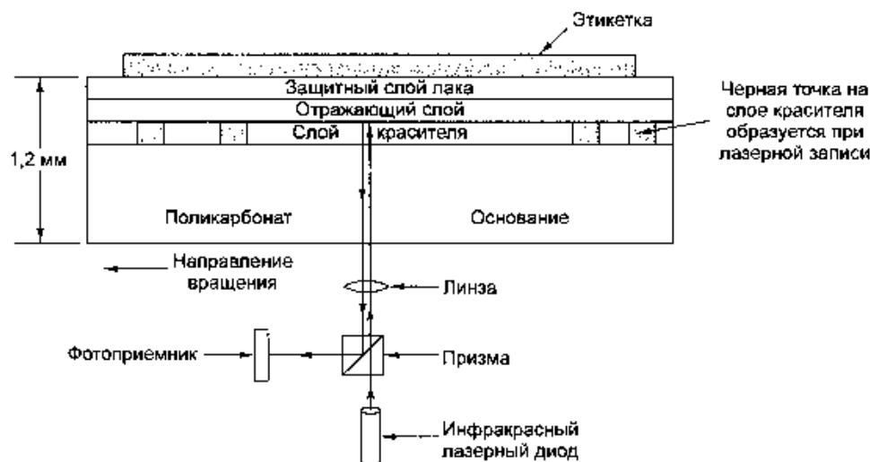
Рис. 2.22. Поперечное сечение диска CD-R и лазера (масштаб не соблюден). Обычный компакт-диск имеет близкую структуру, но у него отсутствует слой красителя, а вместо слоя золота используется слой алюминия с лунками
