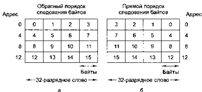
Рис. 2.9. Память с прямым порядком следования байтов (а); память с обратным порядком следования байтов (б)
