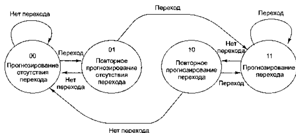
Рис. 4.29. 2-разрядный конечный автомат для прогнозирования переходов
