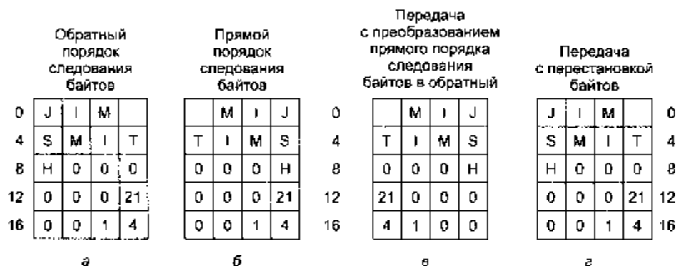
Рис. 2.10. Запись данных о сотруднике для машины с прямым порядком следования байтов (а); та же запись для машины с обратным порядком следования байтов (б); результат передачи записи с машины с прямым порядком следования байтов на машину с обратным порядком следования байтов (в); результат перестановки байтов в предыдущем случае (г)
