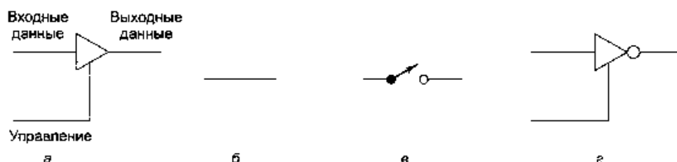
Рис. 3.29. Буферный элемент без инверсии (а); представление буферного элемента без инверсии, когда сигнал управления равен 1 (б); представление буферного элемента без инверсии, когда сигнал управления равен 0 (в); буферный элемент с инверсией (г)
